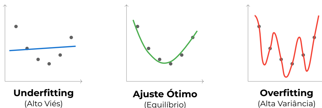
Figura 1: Analogia visual: o modelo Underfit é simples demais (uma reta); o Ajuste Ótimo entende a tendência real do problema; o Overfit cria regras hipercomplexas para decorar até o ruído.
